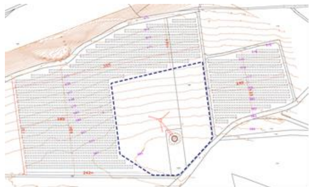
Bild 7 6MWp Planung Freiflächen PV an bestehender WEA in 2022
